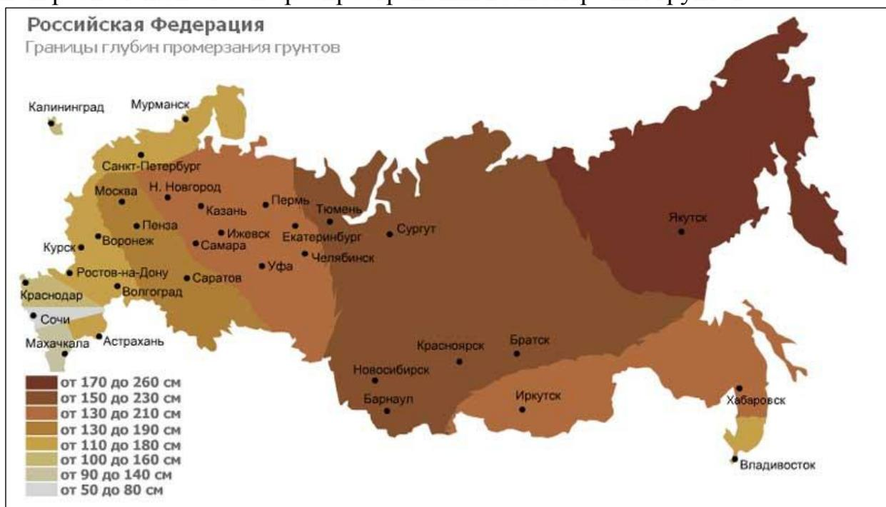
Рисунок 1.3. Границы глубин промерзания грунтов
